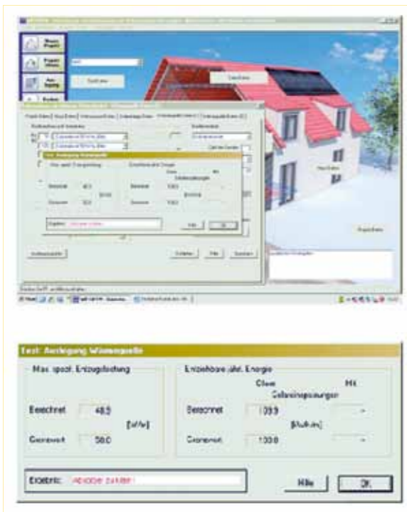
Durch den höheren jährlichen Entzug ist die Quelle zu klein ausgelegt.
