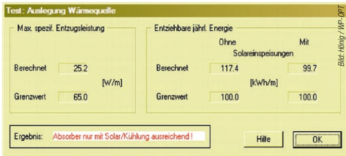
Bild 4 Auslegung der Wärmequelle mit Solareinspeisung bzw. Kühlung.
